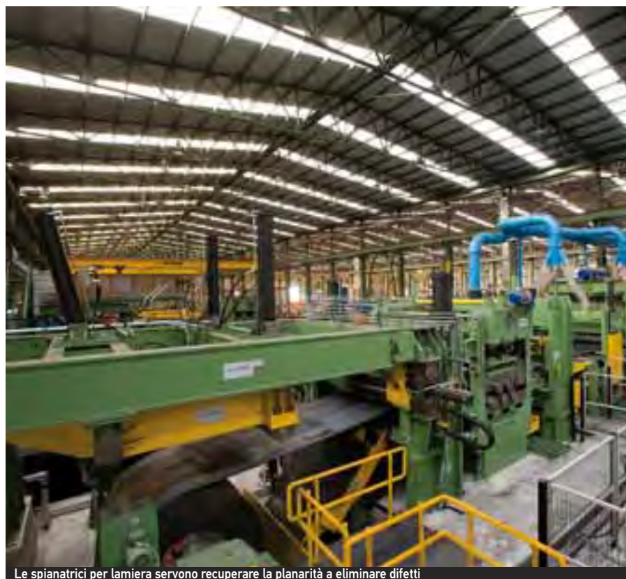
Le spianatrici per lamiera servono recuperare la planarità a eliminare difetti
