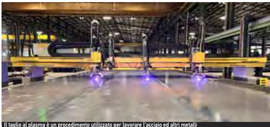
Il taglio al plasma è un procedimento utilizzato per lavorare l'acciaio ed altri metalli
